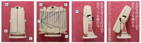
国のボタンを押してサイドパネルを開けてください。パネルは回の内蔵のばねにより自動的に開きます。 パネルが開いたらそれ以上は無理に開かないでください。団の固定ノブを反時計回りに緩めて、利用 しやすい角度に調節してから、時計回りに締めて固定してください。
